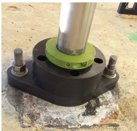
Łożysko ścienne HMAX z tworzywa sztucznego, wały obracają się łatwo, brak potrzeby smarowania
